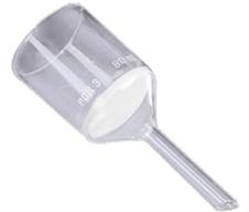
Diese Fisherbrand™ Glastrichterfilter mit integrierten Filterscheiben aus Sinterglas werden aus Borosilikatglas hergestellt und sind im Porositätsgrad 3 (Porengröße 16 µm bis 40 µm) und Porositätsgrad 4 (Porengröße 10 µm bis 14 µm) erhältlich.
